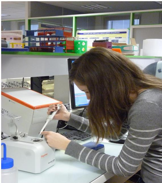
Pour se faire, une série de réactions permettant la réplication d'une matrice d'ADN double brin est répétée en boucle. Ainsi, au cours de la réaction PCR, les produits obtenus à la fin de chaque cycle servent de matrice pour le cycle suivant, l'amplification est donc importante.
